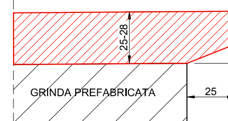
SECTIUNE LONGITUDINALA ZONA DE CAPAT DE PE CULEI SCARA 1:20
